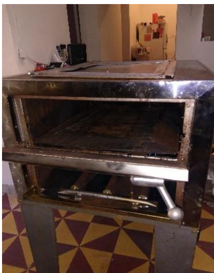
Imagen 1. Adecuación del interior de la cámara para deshidratación por radiación
