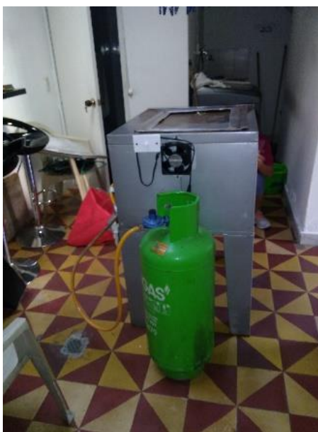
Imagen 4. Adecuación de sistemas de extracción, combustible y medidores de consumo.
