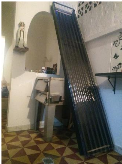
Imagen 3. Componentes básicos del sistema (panel solar y cámara de secado).
