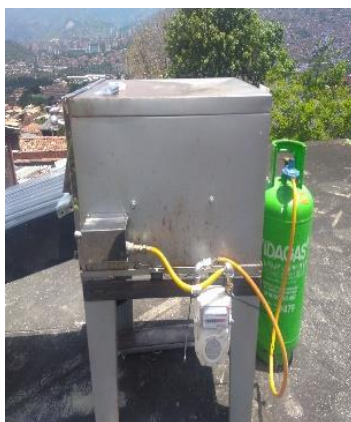
Imagen 9. Sistema de medición y registro y control de temperaturas y consumo de gas.
