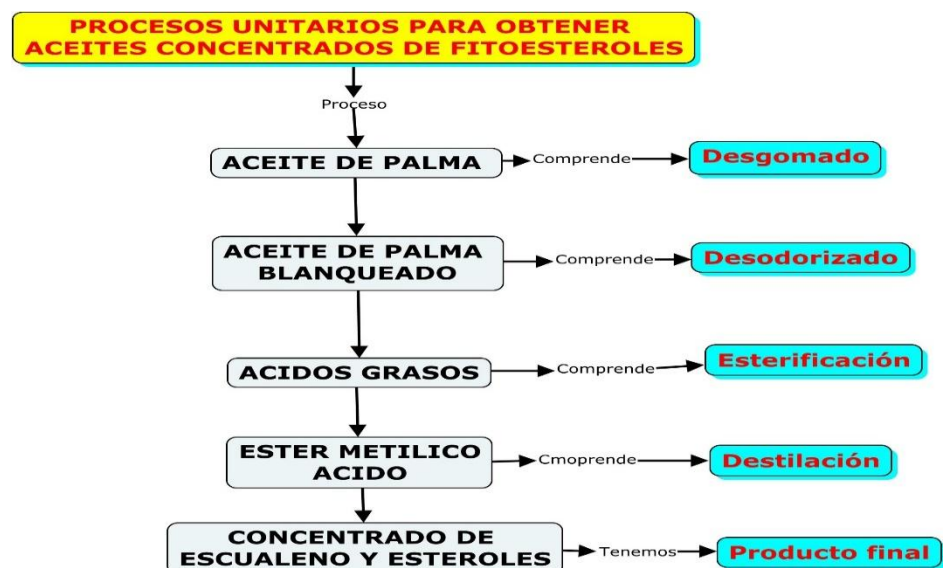
Figura: 2. Procesos unitarios para obtener aceites concentrados de fitoesteroles.
