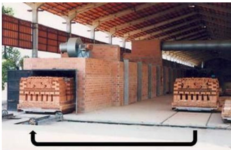
Figura 5. Horno de cámara Fuente: Arias, L. & Arias, I. (2014).
