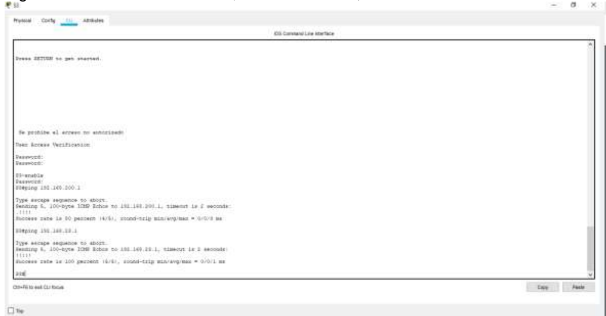
Figura 8. Conectividad S3 a R1, VLAN 200 Y R1, dirección VLAN 23
