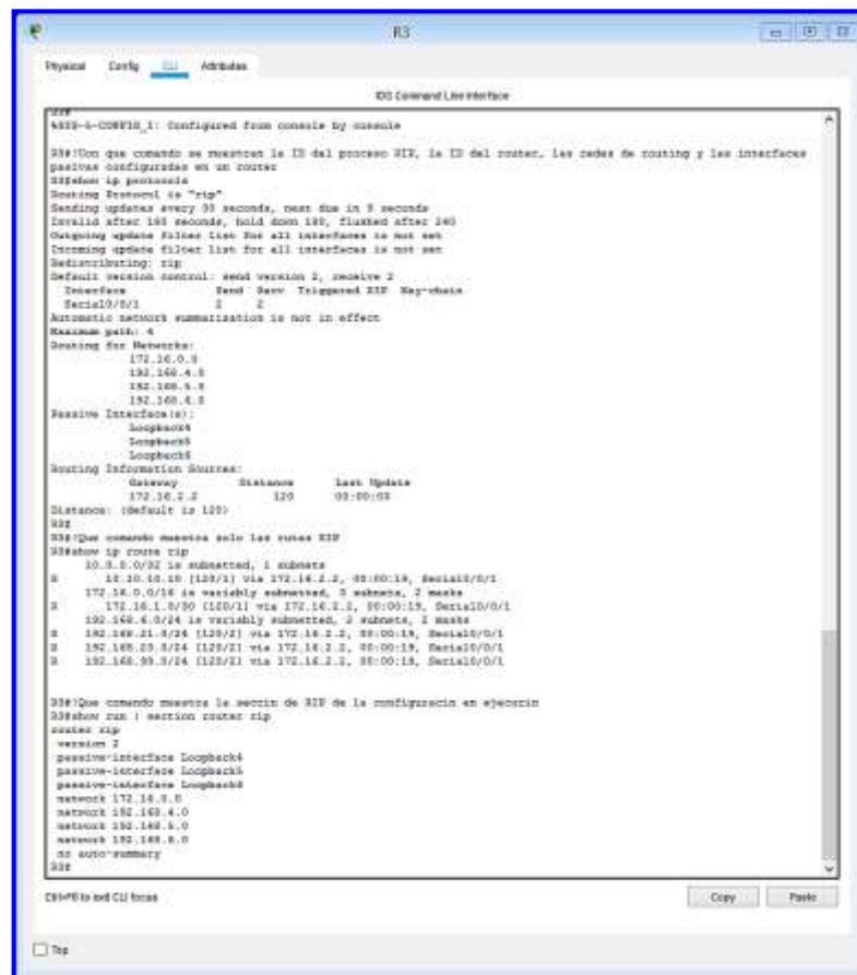
Fig.7. Comprobación y Verificación del funcionamiento de RIPv2 en el CLI de R3
