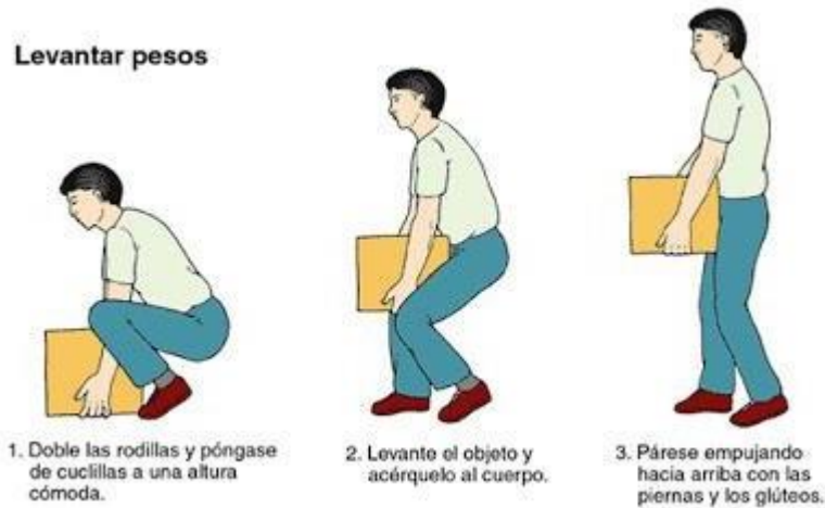
Figura 16. Levantamiento de cargas
