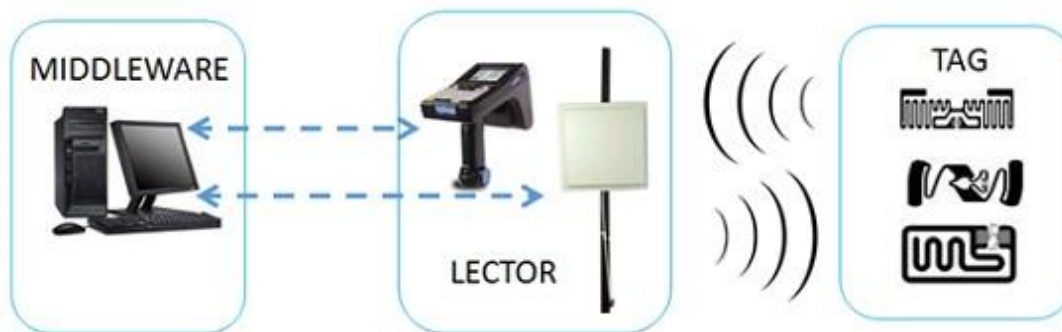
Figura 28. Elementos que componen RFID
