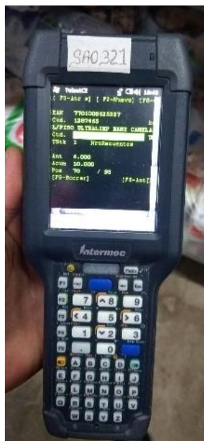
Figura 27. Equipo de Radiofrecuencia utilizado en la bodega de almacenamiento de Sao La Pajuela
