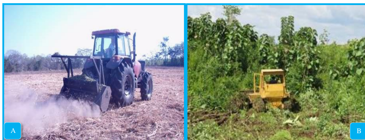
Figura 41. Desmote. (A) Tractor con mulcher. (B) Buldócer. UOLG. Reforestadora de La Costa S.A.S. Municipio de Sabanas de San Ángel, Magdalena. (Fuente: El autor (2019).
