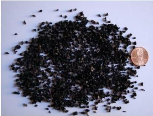
Imagen 12. Granos de diferentes granulometrías de goma que pueden variar 0,5 q 3mm Fuente: Vivo en Italia, (2009)
