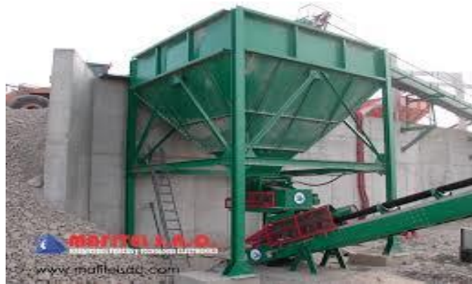
Figura 4: Tolva para Depositar Minerales Granulados (“Tolvas Industriales”, 2020).
