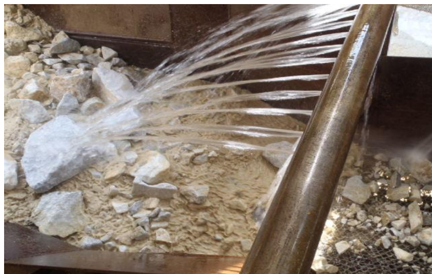
Imagen 4. Entrada al sistema de lavado (autoría propia).
