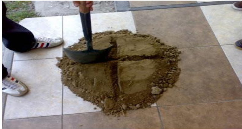
Figura 16. Cuarteo tipo Torta (“¿Qué es Cuarteo de suelos?”, s/f).
