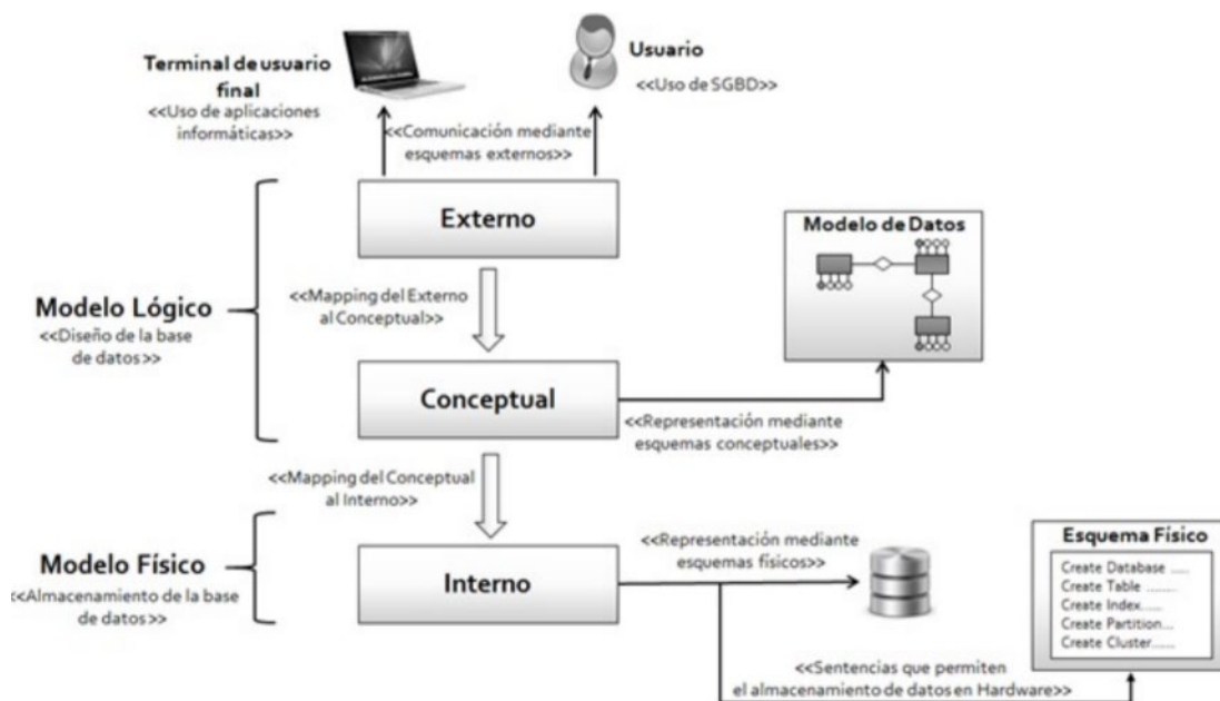
Figura 2. Abstracción de un modelo de datos.
