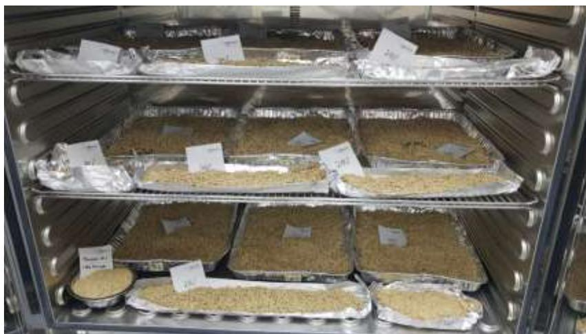
Figura 10. Pellets en el horno en proceso de secado. Fuente: Autor, (2020)
