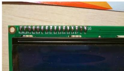
Figura 5. Pines soldadas del LCD 16x2.
