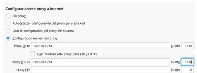
Figura 35. Configuración del Proxy en el navegador
