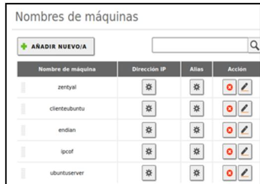
Figura 8. Clientes agregados para servidor DNS
