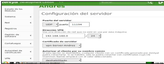
Figura 74. Configuración de certificado en servidor.
