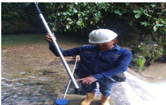
Figura 3. Aforo de caudal sobre el río. Fuente: Autor
