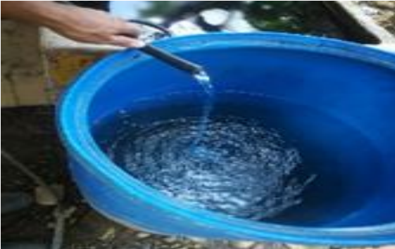
Figura 30. Aforo en vivienda de finca Los Yopos. Fuente: Autor
