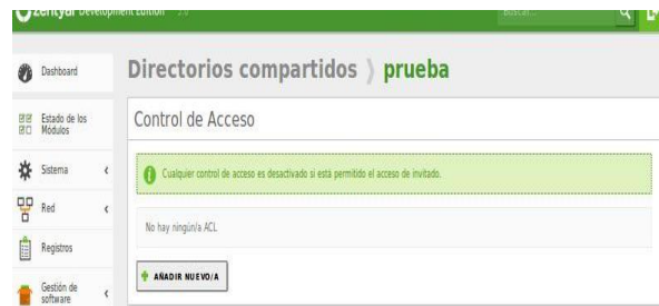
Figura 51. Configuración control de acceso
