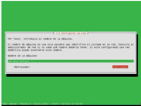
Figura 3 Instalación de Zentyal configuración de red
