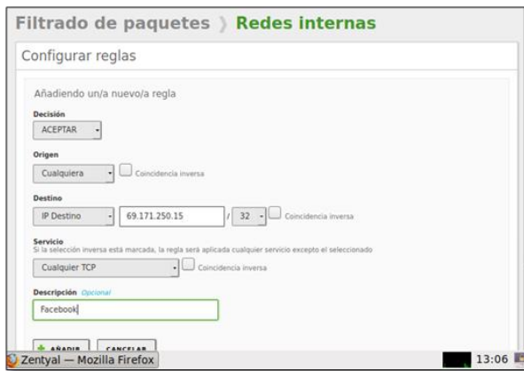
Nieto, C. (2021). Configuración reglas internas. Imagen 31. Elaboración propia
