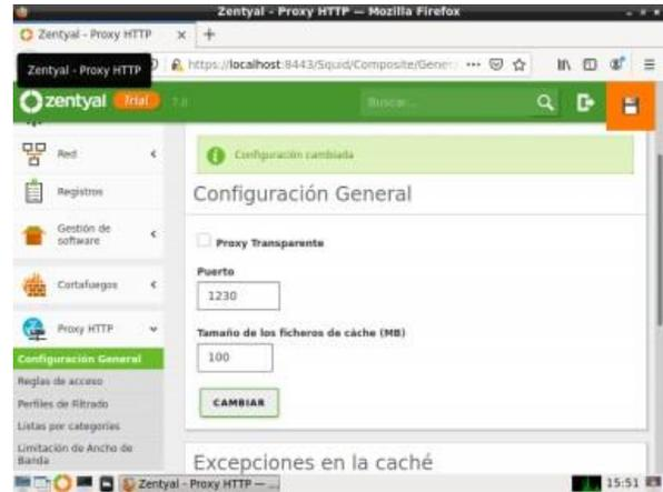
Imagen 16. Configuración general proxy, ilustración propia.
