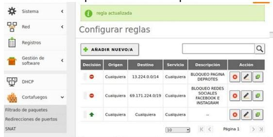
Imagen 42. Reglas de filtrado creadas, panel cortafuegos. Ilustración propia.
