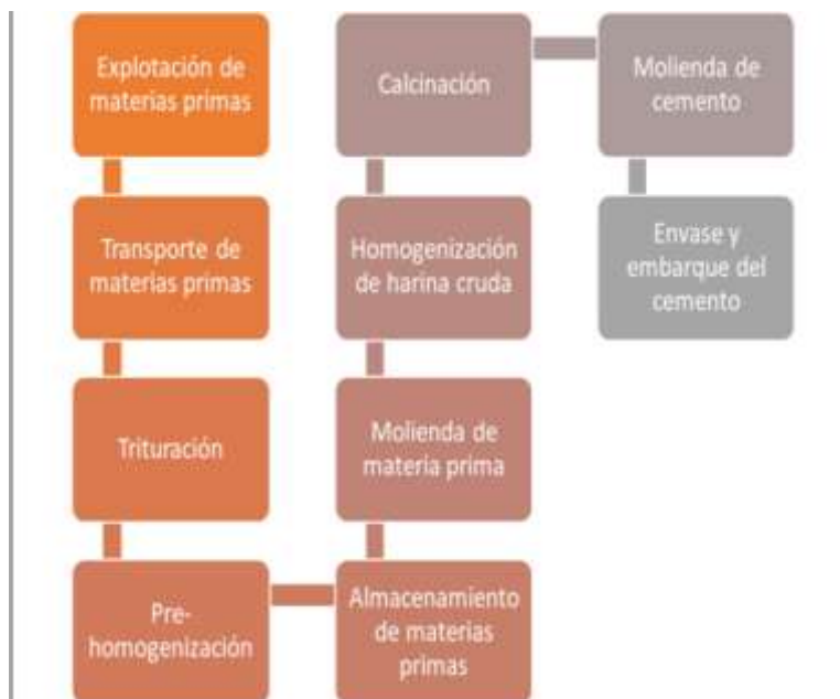
Ilustración 7. Proceso productivo de cemento gris en la cementera Cartagena
