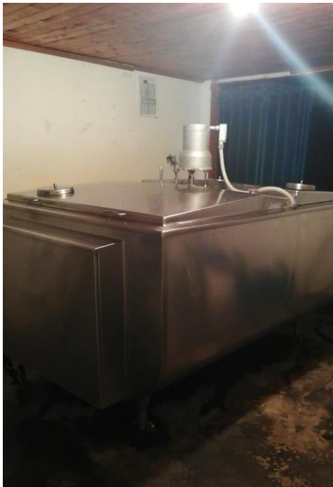
Figura 10 Tanques de enfriamiento
