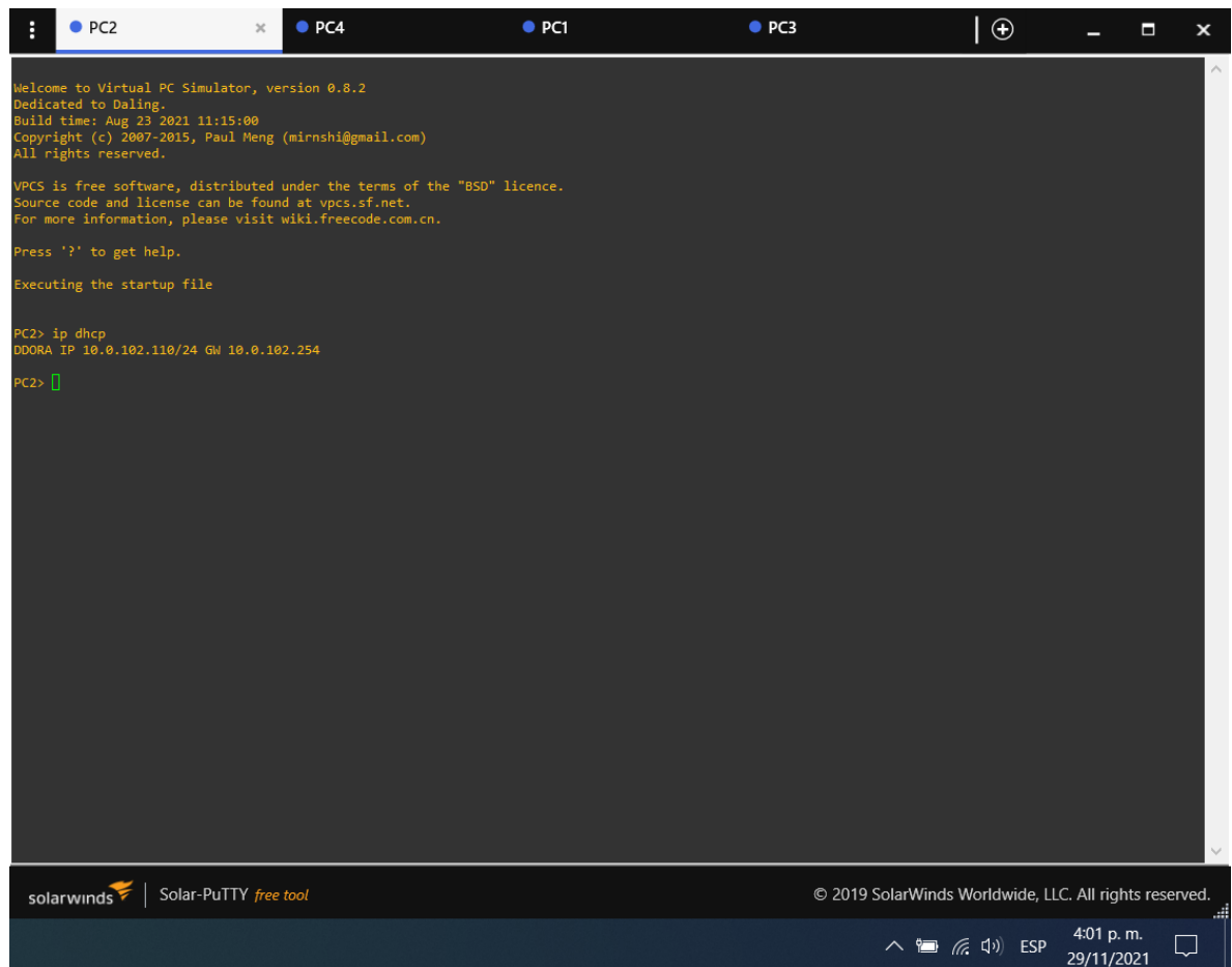
Figura 2. Verificación de los servicios DHCP IPv4 en PC2.
