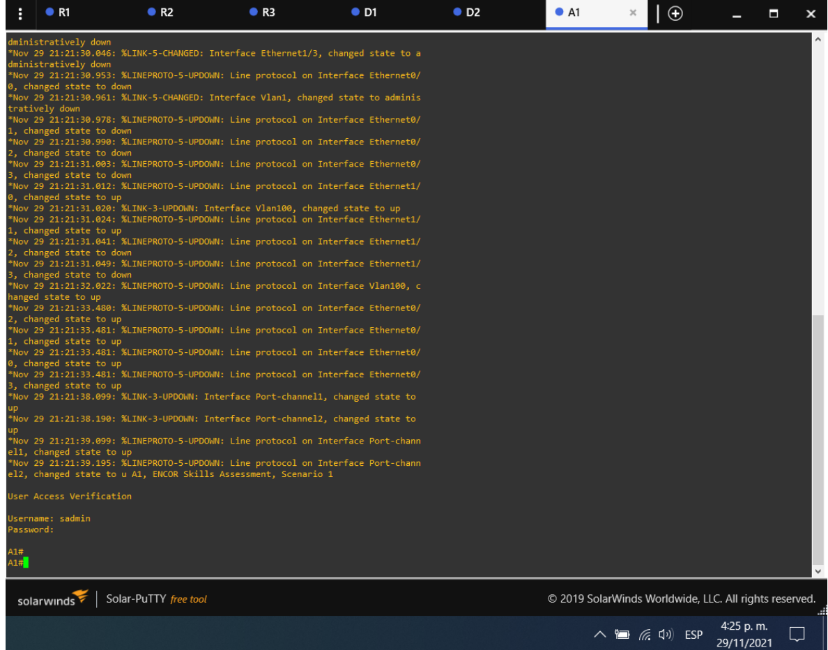
Figura 12. Verificación del servicio AAA en A1.
