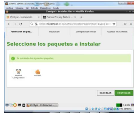
Imagen 30 - Instalación de paquetes Red y FW.
