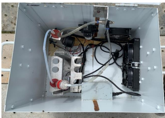
Figura 18. RAC, Con sistema de enfriamiento/calefacción. Bomba de succión. (Analizador de tres gases).
