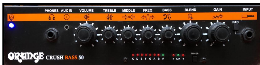
Figura 8. Ecualización bajo eléctrico
