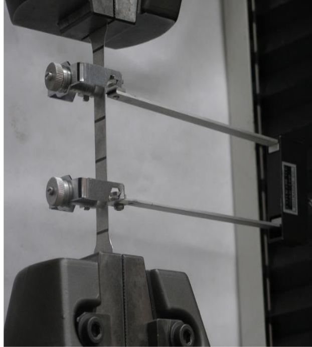
Figura 3. Montaje de la probeta entre las mordazas (Barbosa, J. E., 2008).
