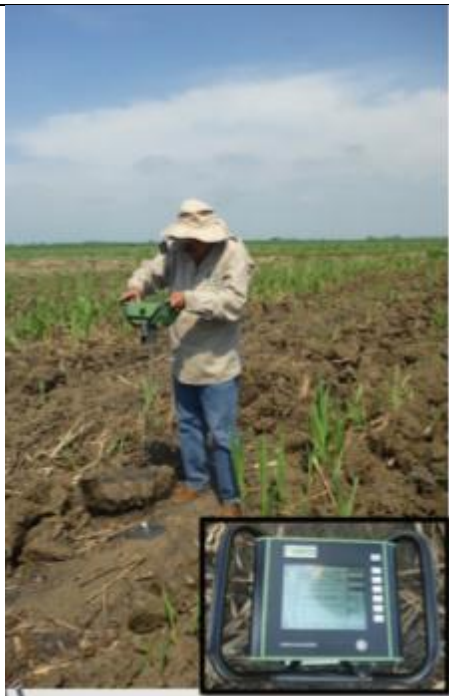
Figura 28. Medición de resistencia a la penetración. Tomado por el autor.
