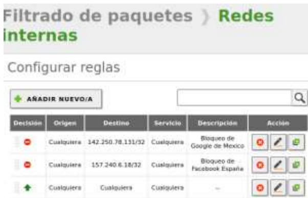
Figura 61. Reglas de filtrado – Red Interna.
