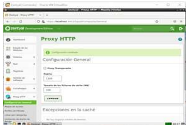
Figura 25. Estableciendo la configuración general de HTTP Proxy.
