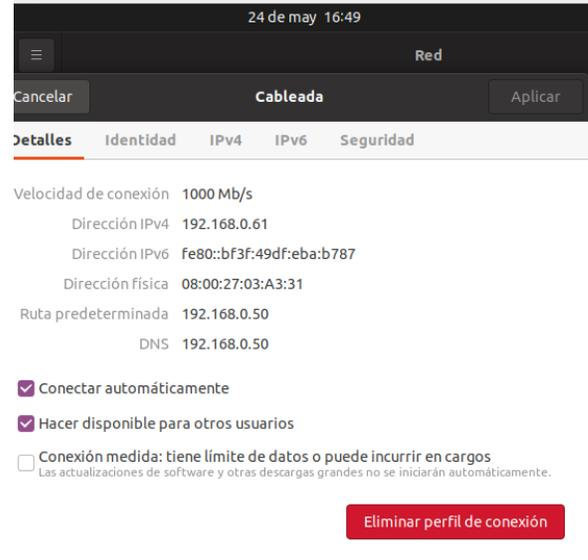
Fig. 21. Comprobación de DHCP y DNS en cliente Ubuntu
