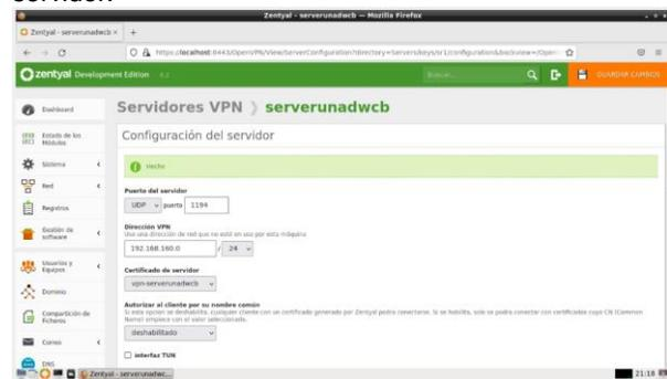
Fig. 73. Configuración de servidor VPN
