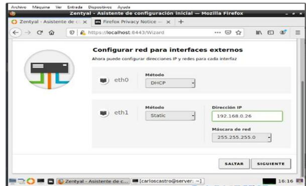
Fig. 26. Evidencia de tarjetas de red DHCP & red interna
