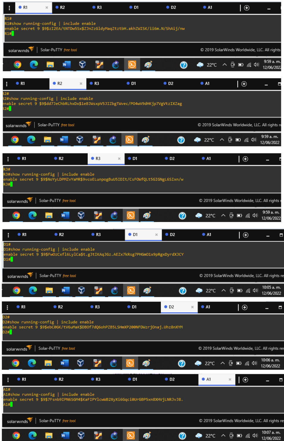
Figura 30. Comprobando la configuración de clave de acceso al modo privilegiado en los dispositivos R1, R2, R3, D1, D2, y A1
