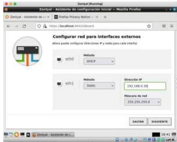
Imagen 28 El adaptador externo, se configura como DHCP y el interno Static y con una IP asignado, para este caso 192.168.0.30
