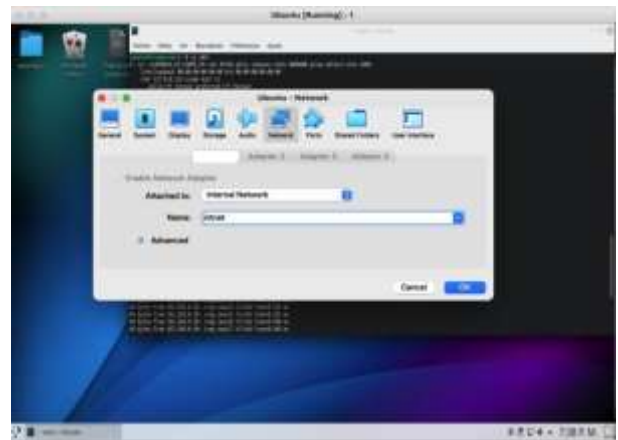
Imagen 34 Luego en la máquina de usuario, se configura el adaptador de red físico, que pertenezca a la misma red
