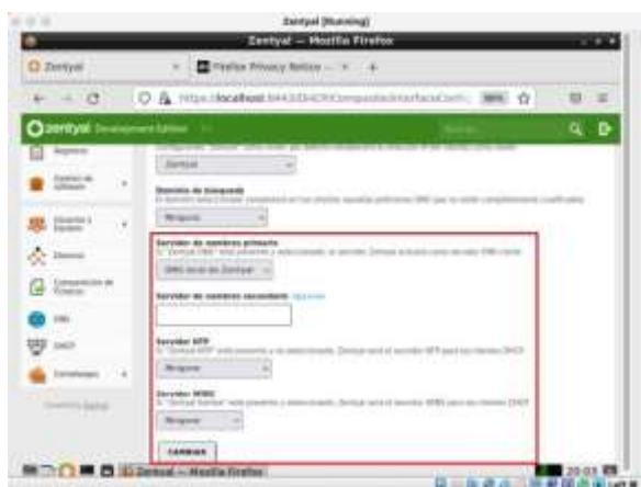
Imagen 39 Se realiza la configuración en el DHCP. Se verifica el Srv denombres primario, sea el de Zentyal
