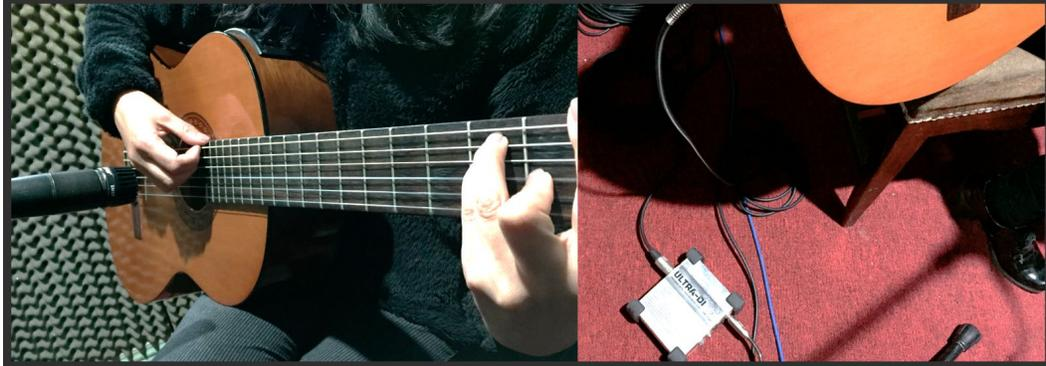
Para la grabación de la vihuela se utilizó un micrófono de condensador de diafragma pequeño entre la última parte del mástil y la boca del instrumento con una distancia de 20 centímetros. Tal y como se observa en la Figura 10.
