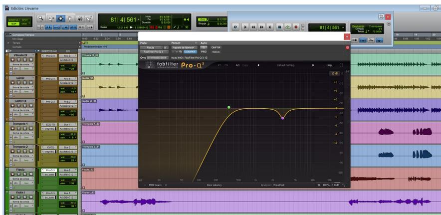
Para complementar este sonido utilizamos el plugin compresor de la marca brainworx “bx\_opto” ligeramente modificado con respecto a los violines pero que nos permite mezclar los colores de la flauta y las cuerdas, variamos el sidechain hacia los 10KHz donde la flauta tiene más contenido de armónicos, de igual forma también aumentamos el control del peak reduction. Tal y como se observa en la Figura 28.
