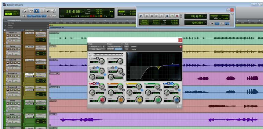
Para completar el sonido de las trompetas utilizamos un compresor bastante rápido y discreto de la marca brainworx “VSC-2” que nos ayuda a compensar los picos muy altos del sonido del instrumento y logra un sonido más homogéneo. Utilizamos un ratio de 2 a 1, un ataque no tan rápido 10ms y un reléase más rápido en relación al ataque de .3ms. Tal y como se observa en la Figura 26.
