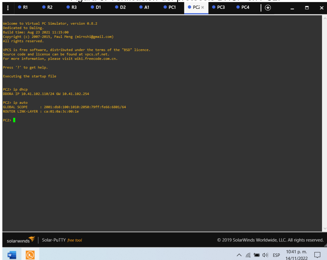
Figura 3. Verificación del protocolo DHCP en PC2.
