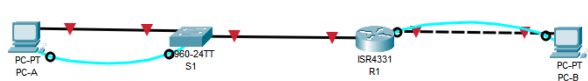
Figura 2: Topología en Packet Tracer.
