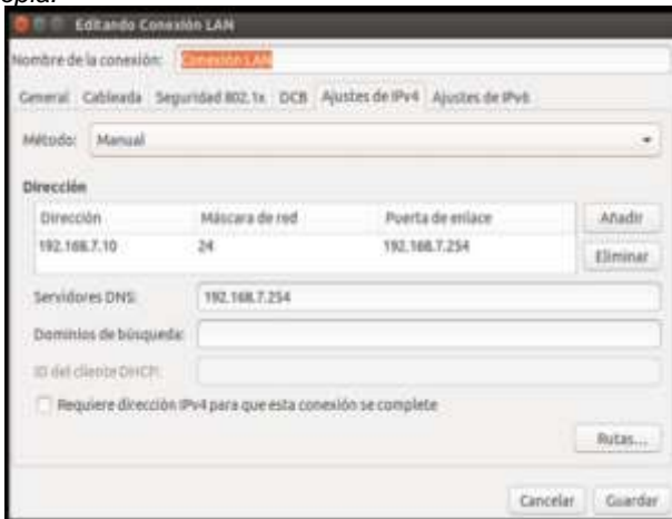
Figura 13. Configuración de la red LAN. Elaboración propia.
