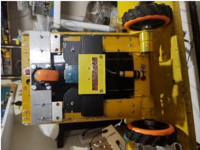
Instalación de Nuevos sensores, Qtr 8RC y modulo REFID, Sensores de Proximidad, Sistema de Locomoción en versión final del Robot
