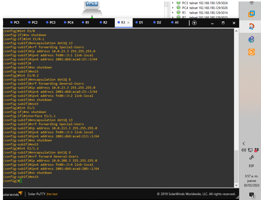
Figura 17. Configurar IPv4 y IPv6 interfaces sobre cada VRF R3
