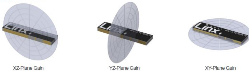
Figura 44. Modos de radiación antena splatch sp610
