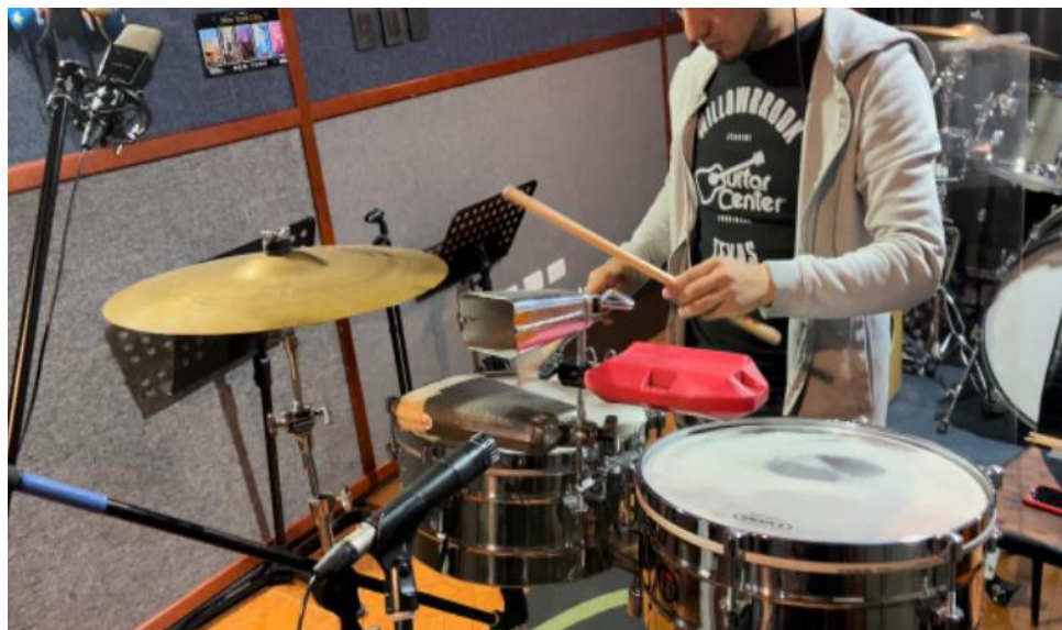
Figura 12. Microfoneo para el timbal, campanas y platillos.
