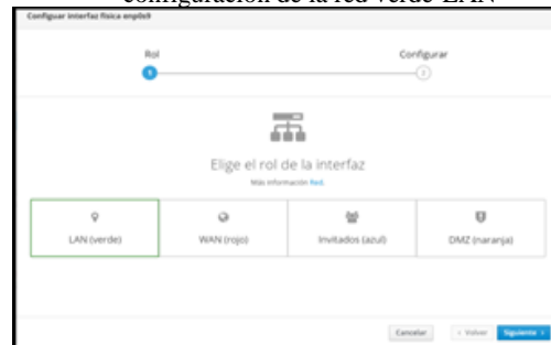
Figura 40. En la siguiente interfaz se realizará la configuración de la red verde-LAN
