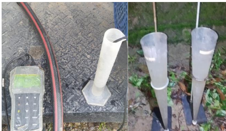
Figura 28. Medición del pH con el potenciómetro EQL 370 y medición de temperatura con el termómetro EQL 374
