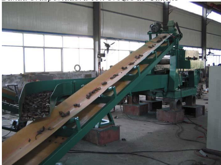
Banda Transportadora con Trozos de Caucho
