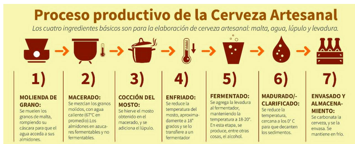
Figura 36 Proceso que se llevan a cabo en la elaboración de cerveza artesanal
