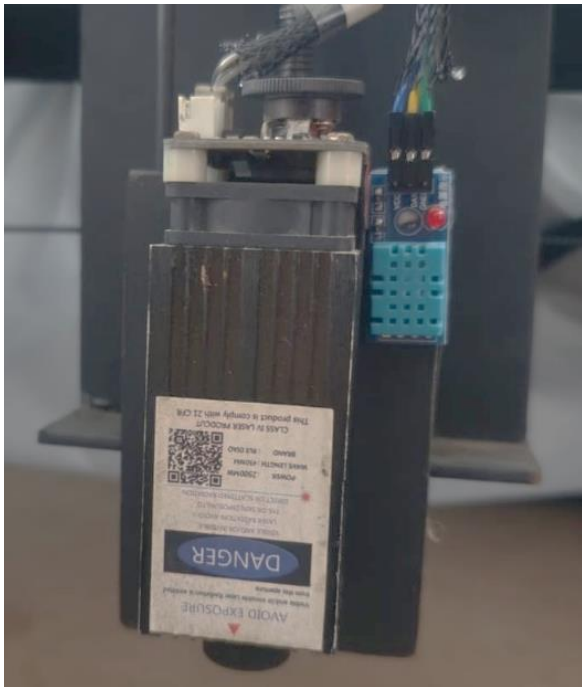
Laser Instalado 2500mW
