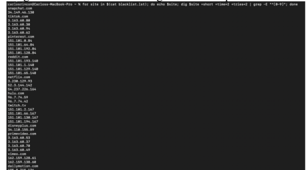
Figura 24. Uso de comando dig en bucle for para extraer IPs
