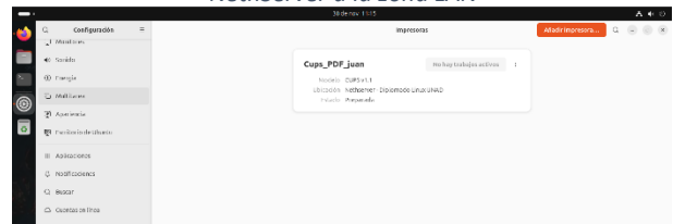
Figura 73 Verificación de la impresora compartida desde el NetServer a la zona LAN
