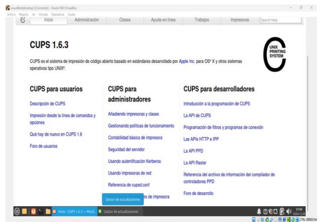
Figura 47. Configuración del servidor de impresoras CUPS (Print Sever) a través de Firefox – Linux Mint (cliente), con la dirección https://192.168.1.10:631 .
