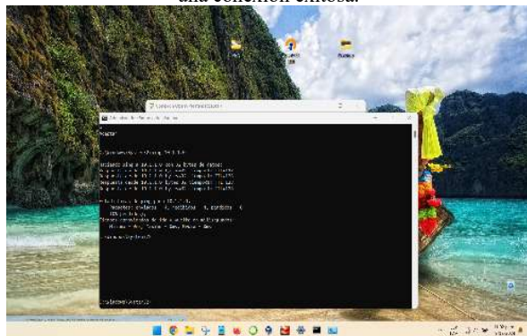
Figura 72. Se realiza un ping a la IP de la VPN y se verifica una conexión exitosa.
