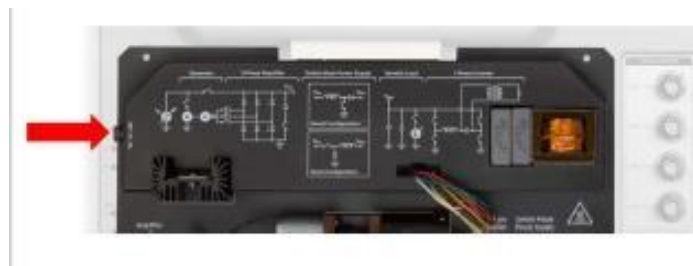
Figura 7 puerto de conexión 24v
