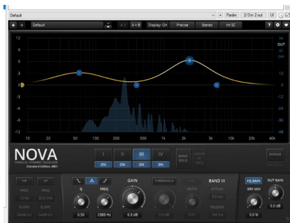
Figura 40. Ecualización congas TDR Nova.
